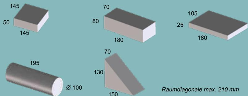
\* Bei minimaler Überschreitung der Abmessungen der Produkte muss die problemlose Handhabung auf jedem Fall geprüft werden, um eine korrekte Ausgabe zu gewährleisten.
